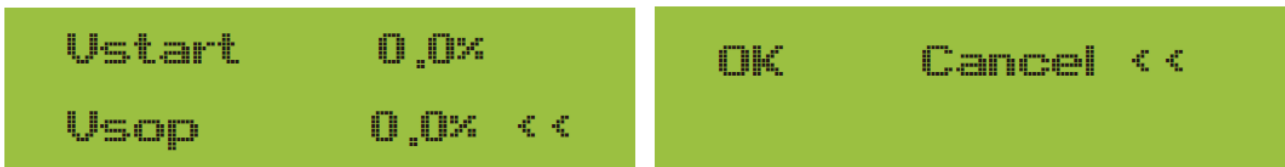
Kuva 8.4.10 LVRT tarkoittaa Low Voltage Ride Through . Tämä toiminto mahdollistaa järjestelmän toiminnan jatkumisen tai palautumisen, vaikka verkon jännite laskee tilapäisesti alhaiselle tasolle. Tämä on tärkeää sähkönjakelun vakauden ylläpitämiseksi ja järjestelmän suojaamiseksi hetkellisten jännitehäiriöiden aikana.
