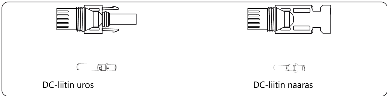
Kuva 5.2.4 Havainnekuva tasavirtapuolen uros- ja naaraspuolen liittimistä.
